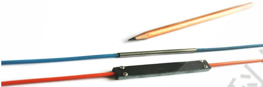
本光纤光栅温度传感器按封装方式分为增敏型与无增敏性封装结构，按外形可分为管式和方形两种。传感器采用了独特的封装技术，不仅可以有效的提高了传感器的温度灵敏度，使传感器能自由的感应结构对象的温度变化，而且消除了外界应变影响，使传感器免受外界应力的冲击。
