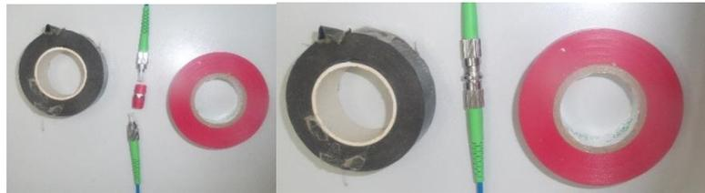
图 5. 光纤端头和光适配合器图光纤连接
