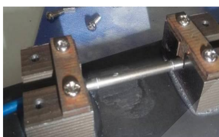
图 3.2 平面固定方式（粘接）
