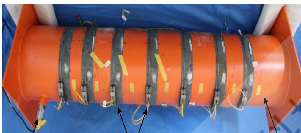
(a)均匀腐蚀管道模型示意图
