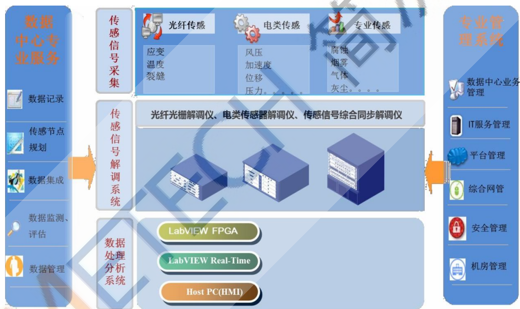
图 3-1 系统体系结构图
