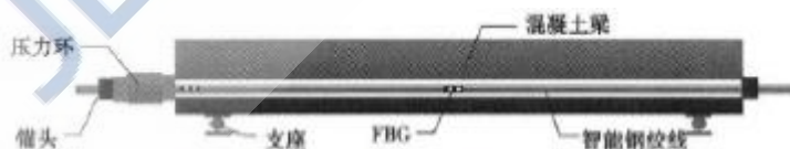
图4 智能钢绞线内传感器布置示意图
