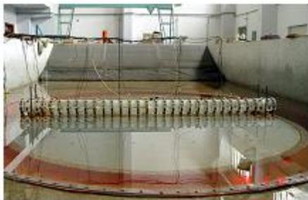
图 7.2 水下振动台及海底管线模型
