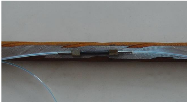
图 3.4 FBG 应变传感器及预应力钢筋 试验所用的预应力钢筋采用后张法施工工艺，而高桩
