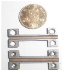
图 3.8 预拉伸夹持装置
