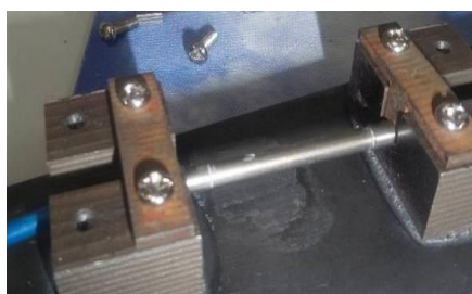
图 3.2 平面固定方式（粘接）
