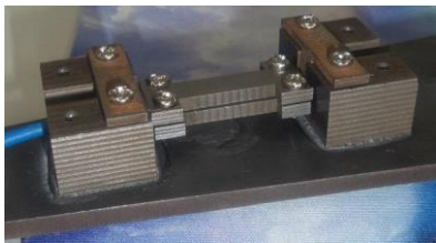
图 3.7 拉伸完成的传感器
